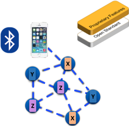
X Y Z Laitteilla eri “rooleja”, jotka otettava suunnittelussa huomioon. “Single points of failure”
